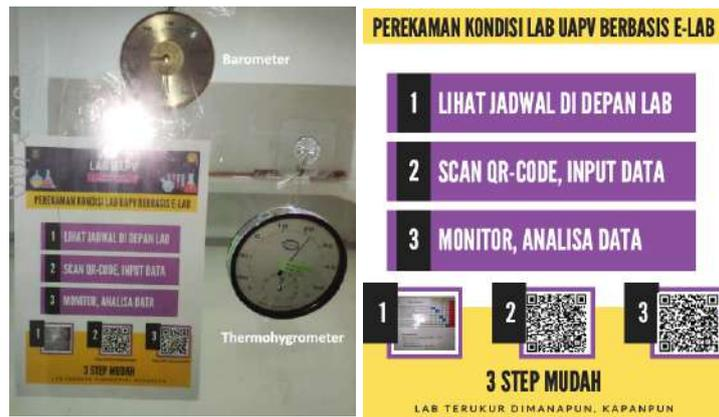
Gambar.2 Alat ukur kondisi lingkungan pada laboratorium UAPV & diagram alirnya
