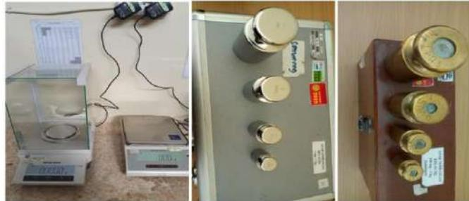
Gambar 1. Peralatan dan bahan penelitian berupa timbangan elektronik, anak timbangan standar dan anak timbangan uji.
